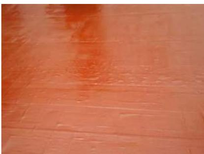
→ Aparición de burbujas de aire a causa de una temperatura excesiva de la superficie.
